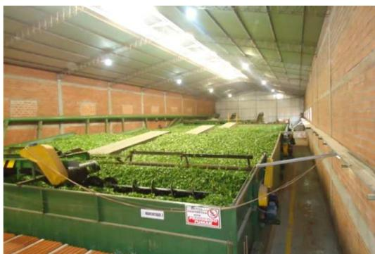
**Figura 2.** Mejoras edilicias de un secadero de té para asegurar la inocuidad del producto. Luces con protecciones y cierre de ventanas abiertas que comunicaban la planta con el exterior.
