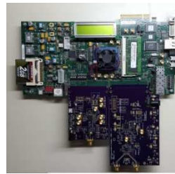
Figura 6: Plataforma construida (FPGA, Transmisor y Receptor).
