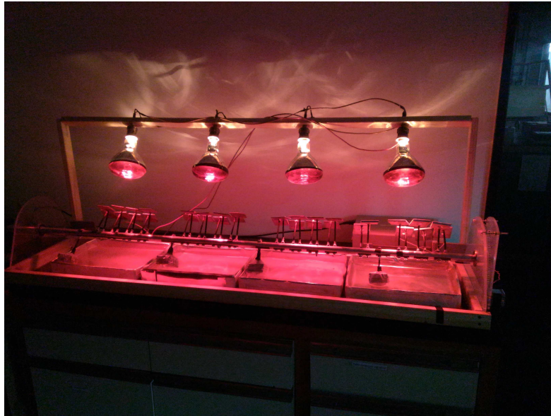
Figura 2: Equipo para evaluación cíclica acelerada de la corrosión por inmersión-secado
