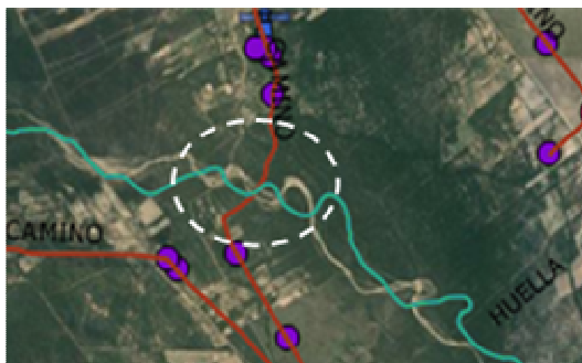
Figura 2. Identificación de la huella normalmente seca de un río inundada luego de una lluvia por un curso de agua interrumpiendo un circuito.
