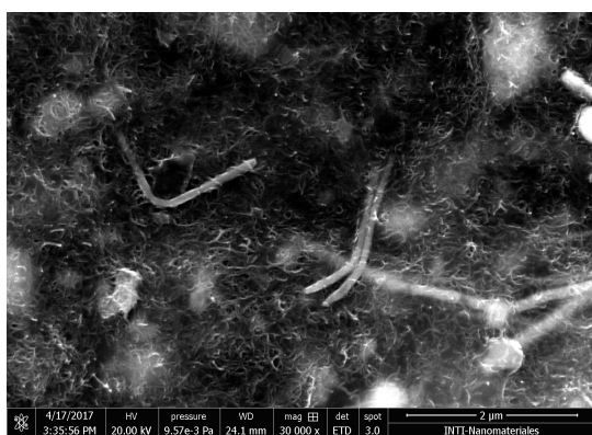
Figura 2: Imágenes SEM de nanocables de cobre (arriba) y de una tinta conductora compuesta por nanocables de cobre y nanotubos de carbono (abajo).
