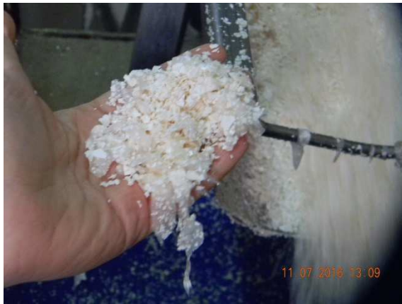
Figura 2: Vista de la cáscara de huevo y de la membrana a la salida del proceso de generación de ovoproductos.
