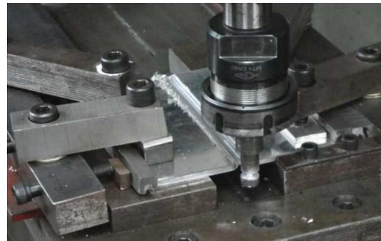
Figura 2: Sistema utilizado para FSW-BT.
