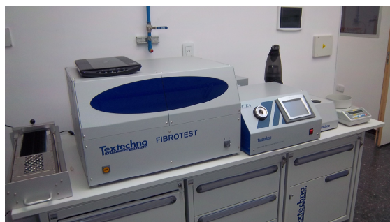
Figura 1: Fotografía del conjunto de instrumentos que componen el CCS (Cotton Classification System), fabricado por la empresa TexTechno GmbH.
