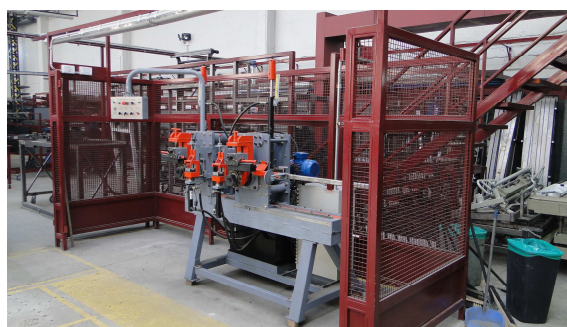
Figura 2: Máquina dobladora ya ubicada en zona de producción
