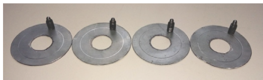
Figura 3: Anillos y punzones usados en el pin-on disk
