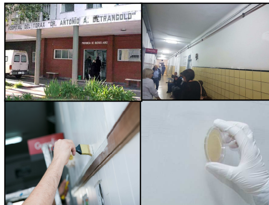
Figura 1: Áreas crítica del hospital Cetrángolo, aplicación de pintura bactericida y muestreo con placa Rodac.
