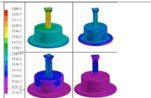
Figura 4. Gráficas de enfriamiento (temperatura °C).
