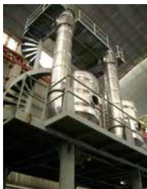
Figura 2. Vista del concentrador de doble efecto al vacío.
