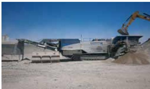
Figura 1: Planta trituradora y clasificadora de hormigón
