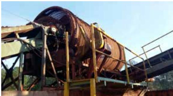
Figura 4. Prototipo de zaranda construido por una empresa almidonera de la provincia de Misiones, actualmente en funcionamiento.
