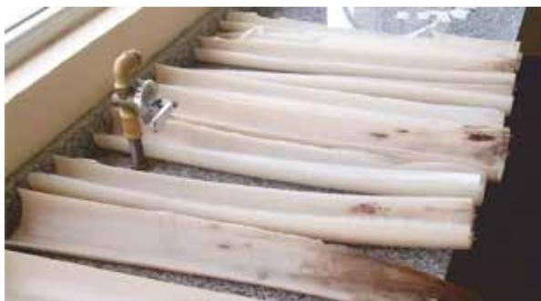
Figura 1. Separación de vainas de banano para elaboración de cintas, realizado por INTI Misiones.
