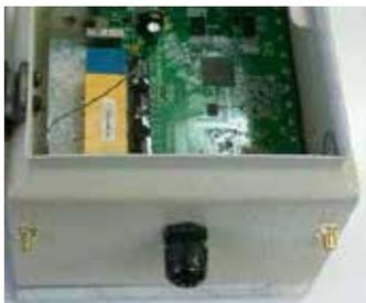
Instalación de la placa del router comercial modificado en el interior del nodo
