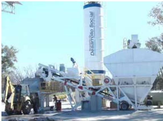
Planta de hormigón montada.
