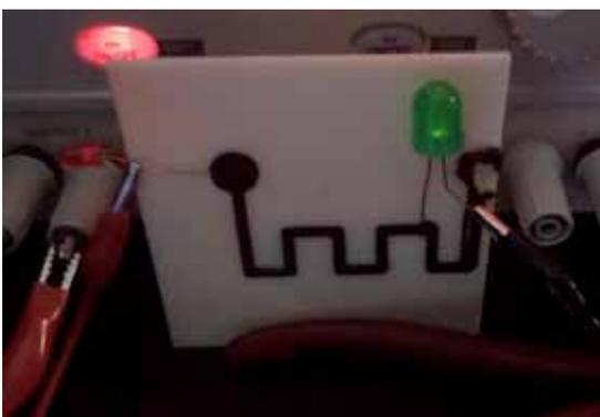
Figura 2. Circuito conductor de PCL/NTC fabricado por impresión 3D
