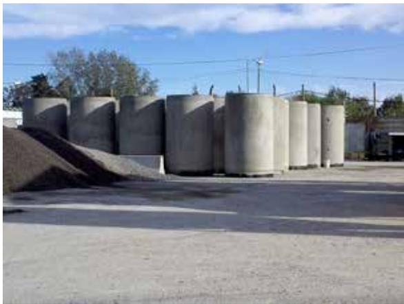
Figura 2. Acopio de caños de hormigón.
