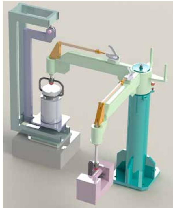
Figura 1. Dispositivo manipulador de pesas y balancín.
