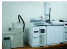
Foto del cromatógrafo gaseoso (derecha de la foto) acoplado al detector de masa (izquierda de la foto).
