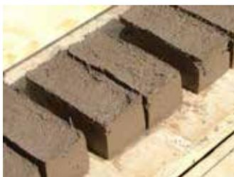
En la fabricación de los adobes se usa tierra tamizada, estiércol equino, agua y paja de trigo, para formar un pastón de barro. Luego los adobes se fabrican con moldes especiales construidos para tal fin. Finalmente, es necesario dejar secar los adobes por un período aproximado de un mes, hasta que puedan ser utilizados.
