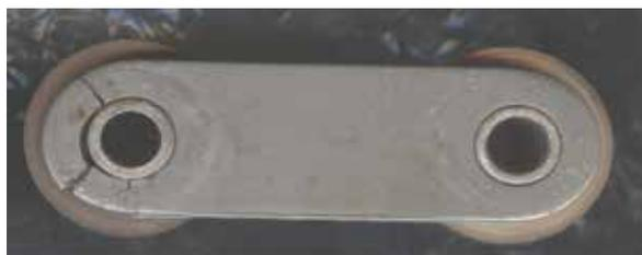
Figura 2: Eslabón fracturado
