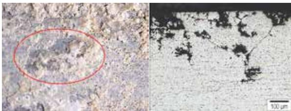
Figura 2: Corrosión bajo depósitos      Figura 3: Metalografía del ataque
