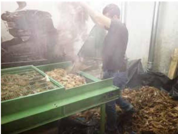
Figura 1. Alimentación de fibra de llama en máquina descerchadora.
