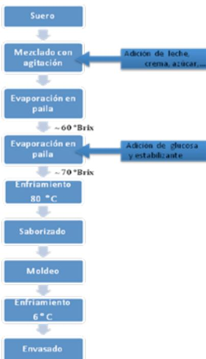
Figura 1. Diagrama de flujo del proceso.
