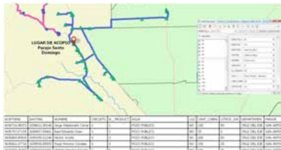
El equipamiento para el GPS fue el TRIMBLE modelo JUNO SD, y el formato de coordenadas geográficas utilizado es funcional al SISTEMA POSGAR 98. El motor de post-proceso del sistema de información geográfica (GIS) fue el Qgis 2.6 de código libre.
