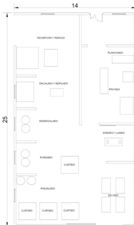
Figura 2. Medidas generales de las instalaciones cubiertas.
