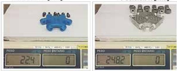
De arriba abajo: Primer prototipo construido y su representación CAD. Distribución del error teórico de posicionamiento en el área de impresión. Mejora de diseño mediante reducción de masas en el efector pieza FDM y pieza mecanizada de aluminio.
