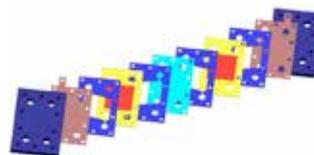
**Figura 5:** esquema del electrolizador tipo stack con configuración bipolar: electrodos colectores (marrón), sellos / contenedores de electrolito (azul), separadores (rojo) y electrodo bipolar de Ni (celestes).
