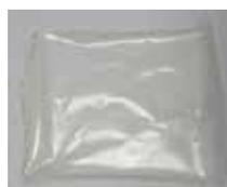
Figura 2. Película tricapa (Q-C-C)
