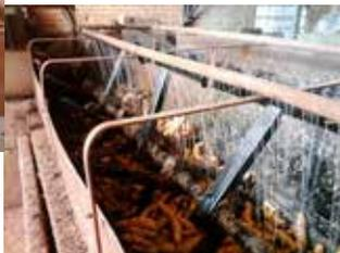
Figura 2. Lavador con agua. Aquí se generan los efluentes líquidos de las fábricas de fécula.
