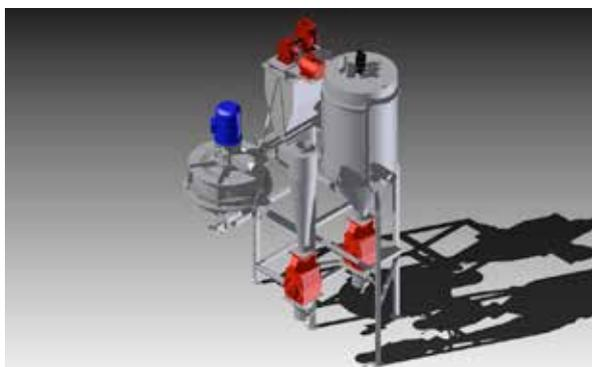
Figura 1: Imagen renderizada del Sistema de Micronizado
