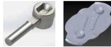
Figura 2. Producto seleccionado y par de piezas forjadas con rebaba.
