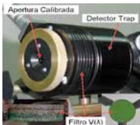
Figura 2 - Detector trap y su filtro V(λ)
