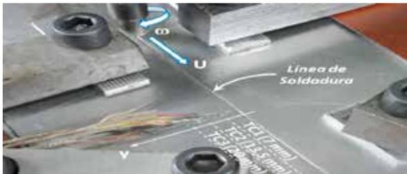
Fig. 1. Equipo para soldar por fricción-agitación y adquirir los ciclos térmicos
