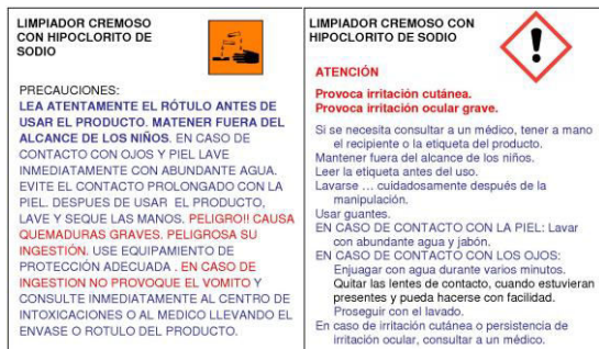
Figura 3: Etiquetas limpiador cremoso con hipoclorito de sodio: actual (izquierda) y SGA (derecha)
