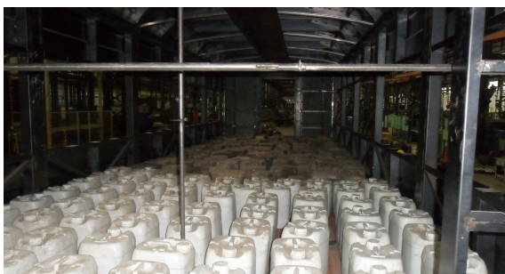
Figura N°7 – Coche motor con la carga correspondiente al peso propio y sobrecarga de uso máxima
