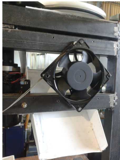
Figura 4: plano inclinado y ventilador de un prototipo de la máquina.
