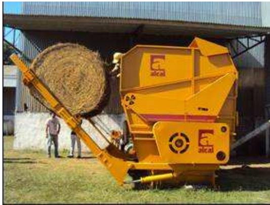
**Figura 2: prueba de uno de los equipos en el Centro, desmenuzadora de rollos.**
