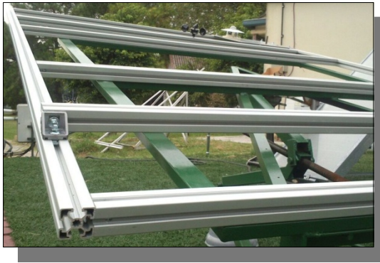
Figura 3: Seguidor Solar Manual – Ensayo Resistencia al Shock Térmico Interno: orienta al captador perpendicular al sol para lograr la acumulación energética requerida por la norma.
