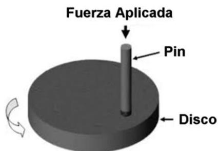
Fig. 1: Esquema conceptual de un equipo pin-on-disk
