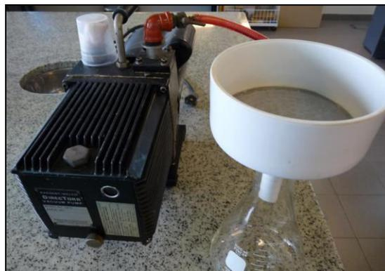
Figura 1: Aparato para formar Pulpa Moldeada.
