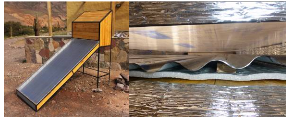
Figura 1: A la izquierda se muestra una fotografía del secador solar. A la derecha es una fotografía en detalle un corte transversal del colector
