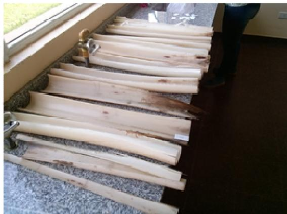
Figura 1: Separación de vainas de banano para elaboración de cintas, realizado por INTI Misiones.
