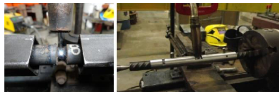
Figura 2: Proceso de soldadura FCAW.
