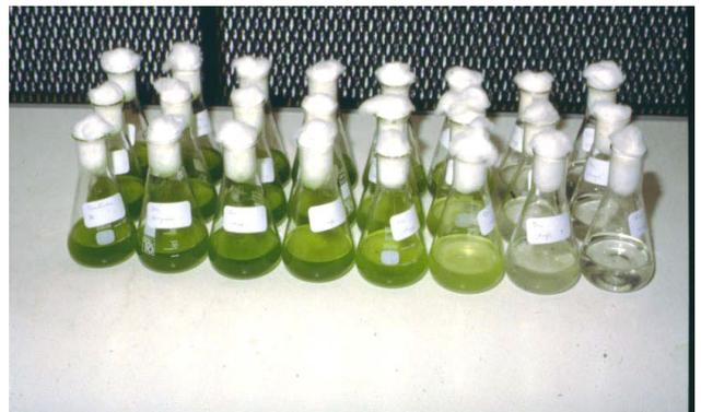
Foto 2: ensayo de toxicidad con cobre
