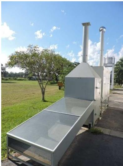
**Figura 2: Secadero multipropósito solar y a leña.**
