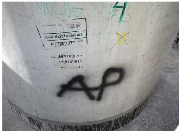
Figura 3: Sello de Conformidad con logo INTI CONSTRUCCIONES e indicación para ensayo de aplastamiento (AP).
