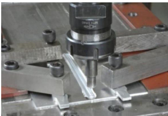
Figura 1: Montaje de las chapas a soldar y dispositivo
