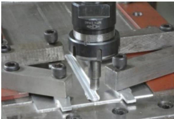
Figura 1: Montaje experimental y junta soldada
