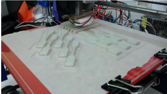
Figura 1: probetas de tracción usando como referencia la norma ASTM D638.
