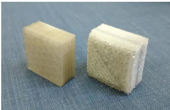
Figura 2: cubos de prueba 100% PETpc con (izquierda) y sin (derecha) secado.
