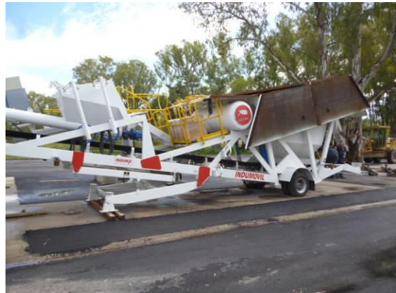
Figura 2: Planta de hormigón sin montaje
