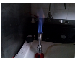
Figura 1: Quema del biogas. El color de la llama es indicativo de buena calidad del gas.
