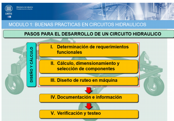
Figura 3: Pasos para desarrollo de un Circuito Hidráulico.
