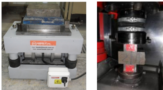
Figura 5: Moldeo y ensayo de resistencia a la compresión.
