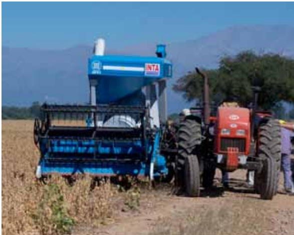
Primer prototipo de la cosechadora de arrastre fabricada en la ciudad de Palpalá por el grupo MOVAL Máquinas de Jujuy.
