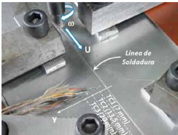
Figura 1. Equipo para soldar por fricción-agitación y adquirir los ciclos térmicos.
