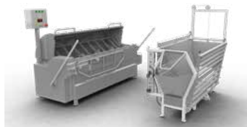
Equipos especialmente diseñados para la unidad de faena móvil: escaladora peladora de cerdos y brete de noqueo.
