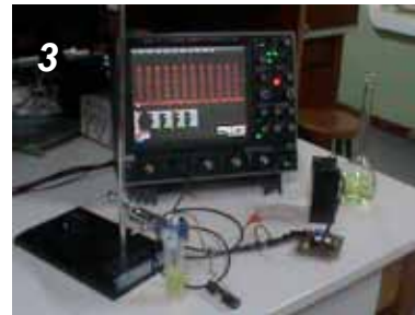
Figura 3. Setup experimental de mediciones de prueba y control con muestras del par rédox ferricianuro/ferrrocianuro.
