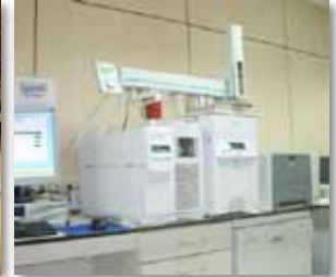
Figura 2. Cromatógrafo GC/MS, acoplado a sistema de inyección SPME.
