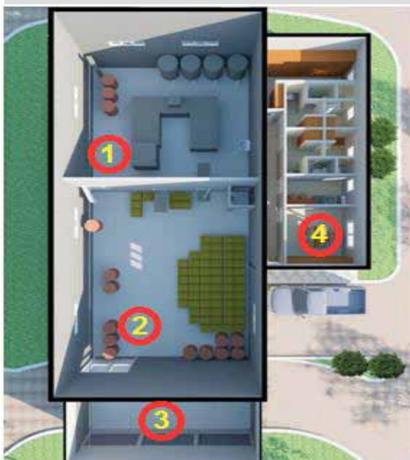
Imagen de corte horizontal de sala de extracción prototipo 2, que contiene: (1) Zona limpia: "Proceso". (2) Zona de transición: "Depósito de material". (3) Zona complementaria: "Carga y descarga". (4) Zona complementaria: "Servicios".
