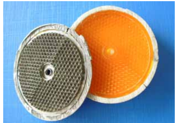
Molde obtenido por electroformado y pieza originante.
