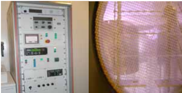
Izq.: equipo de "sputtering" utilizado para producir la película de plata. Der.: plasma generado dentro de la cámara de metalización.
