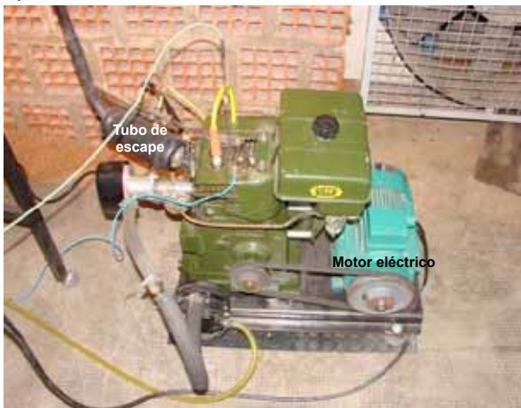
Figura 1. Motor adaptado para funcionar con varios combustibles: nafta, GNC y GNC-H 2 .
