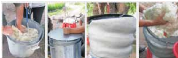
Pruebas de mojado, verificación de volumen y peso, y proceso de escurrido utilizado componentes del prototipo del puesto de teñido.
