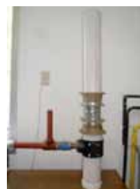
Figuras 3 y 4. Dispositivo para la determinación del coeficiente de permeabilidad del hormigón poroso, según Ley de Darcy.
