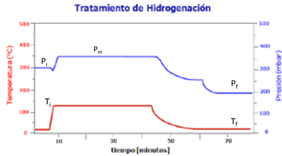
Figura 1. Curvas típicas de hidrogenación, la curva azul indica la presión inicial y la curva roja la temperatura.
