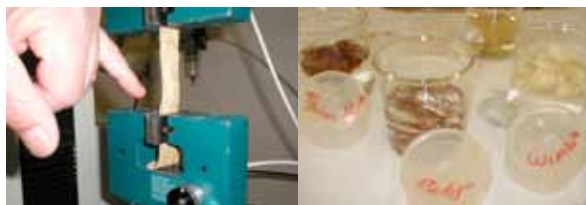
Ensayo de resistencia a la tracción.
