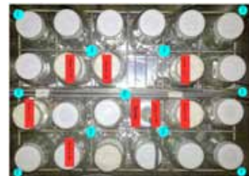
Figura 3. Canastos portabiberones. Ubicación de los sensores de distribución (círculos celestes) y los de penetración (rectángulos rojos).
