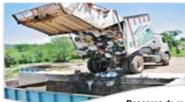
Descarga de residuos indiferenciados para transferencia.
