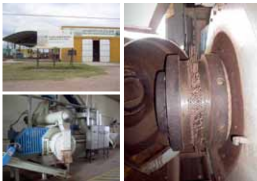
Figura 1. Planta de pellets de aserrín. Matriz de extrusión de X46Cr13.
