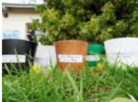
Figura 1. Ovitrampas larvicidas desarrolladas en INTI Plásticos.
