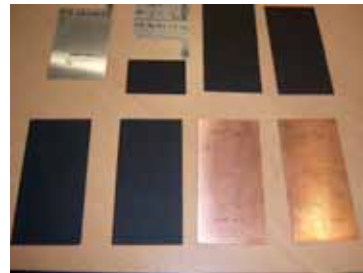
Figura 4. Desarrollo de pinturas y análisis en sustratos Al y Cu.
