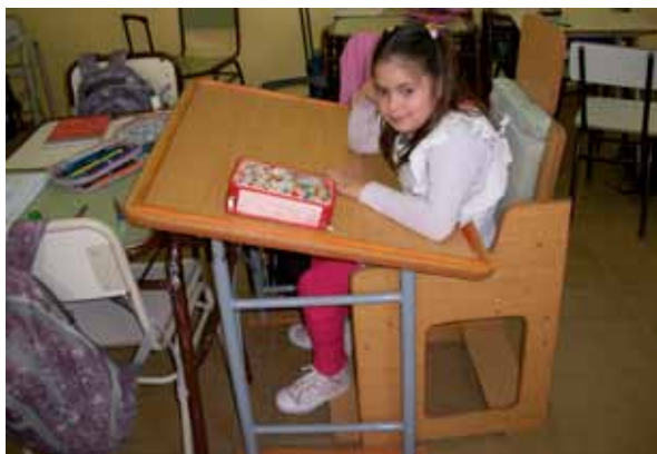
Figura 2. Silla postural y escritorio personalizado para una alumna integrada, construidos por la Escuela técnica con orientación técnico mecánico y la Escuela de capacitación laboral INSR de la ciudad de Villa Regina.
