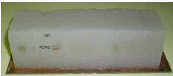
Figura 1. Fantoma hecho de gel bacteriológico y las incrustaciones de PDMS para ser detectados desde la cara superior.
