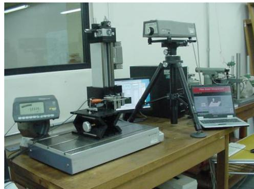
Figura 1: Calibración de un palpador de manera automática
