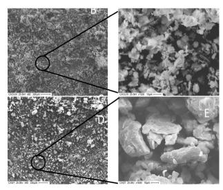
Figura 1. Micrografías SEM de los distintos agentes reforzantes antes de ser incluidos en la matriz polimérica. A) Negro de humo; B) y C) Caolín, D) y E) Montmorillonita.
