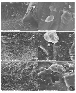
Figura 2. Micrografías SEM de la superficie de fractura (bajo Nitrógeno líquido) de los compuestos M1 (A y B), M4 (C y D) y M5 (E y F).
