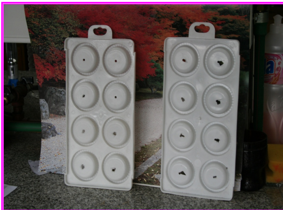
Figura 12. Planchas de plástico utilizadas para que las muestras contacten con los reactivos en los ensayos con 10 ml
