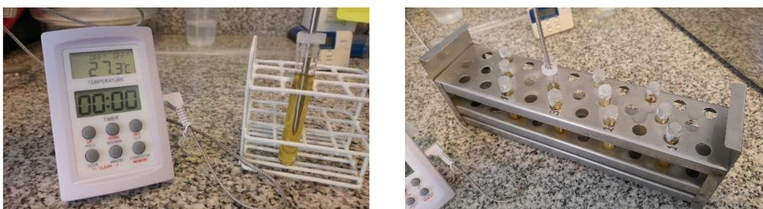
**Figura 5:** Termopar digital y ubicación dentro de tubo de Khan con la muestra; y disposición de los tubos en la gradilla.
