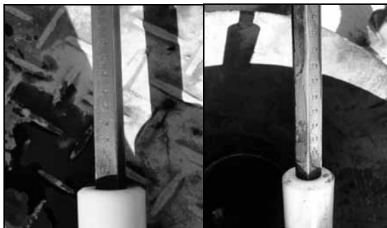
Figura 4: varilla sin pasta (crudo). Varilla con pasta (agua).
