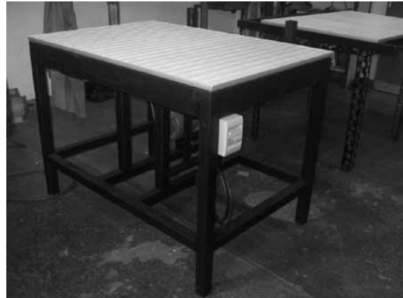
Figura 3: Máquina afieltradora. Plancha que realiza movimientos de fricción, simulando a las afieltradoras industriales.
