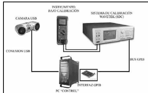
Figura 2: arquitectura general del sistema.
