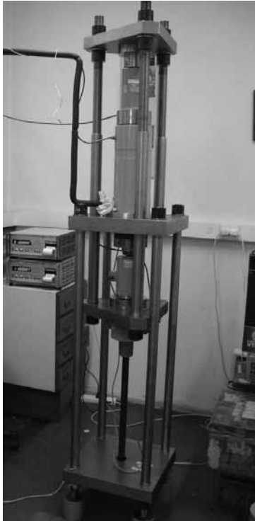
Figura 2: máquina de calibración por comparación de 200 kN.
