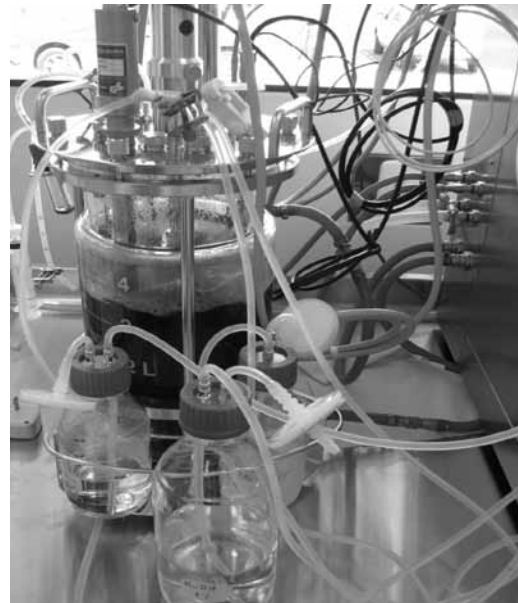
Figura 1: biorreactor con 3 L de medio de cultivo que contiene vinaza/glicerol.
