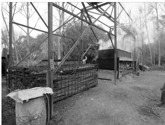
Figura 5: caldera para el hervido de mimbre con la asistencia de un polipasto.
