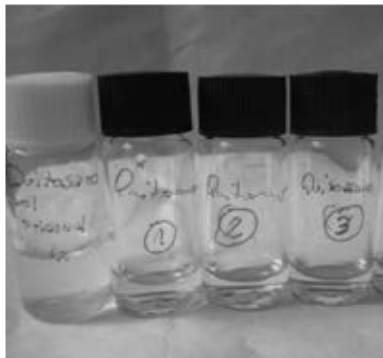
Figura 1: diluciones seriadas de una solución al 1 % de quitosano en ácido acético 1 %.
