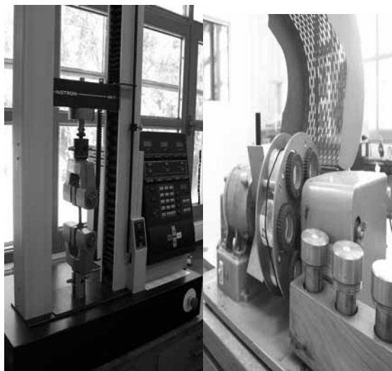
Figura 1: equipo de permeabilidad al vapor de agua y coeficiente de vapor (izquierda), y máquina universal tracción/compresión (derecha) utilizadas en la realización de los ensayos a EPP, bajo la acreditación de la OAA.
