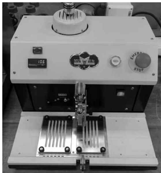
Figura 2: equipo para la realización del ensayo de resistencia al corte por cuchilla adquirido últimamente por el Centro INTI Cueros. Con este equipo se incorporó a la oferta tecnológica el ensayo mencionado que se realiza sobre el empeine de calzados, guantes y mangas de seguridad.
