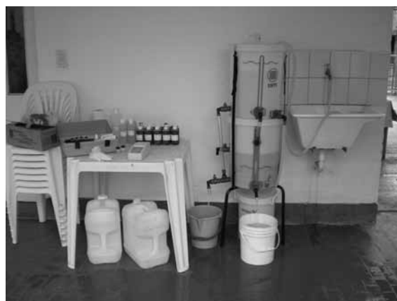
Figura 3: dispositivo rural para abatimiento de arsénico.
