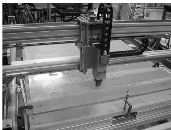
Figura 2: grabado de un cartel en policarbonato.
