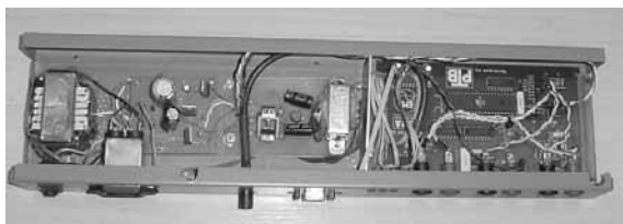
Figura 4: fotografía del sistema de sincronización en el gabinete.
