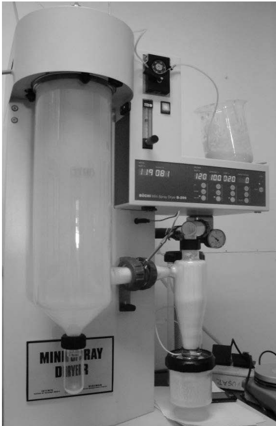
Figura 1: secado por "spray" de la formulación desarrollada.
