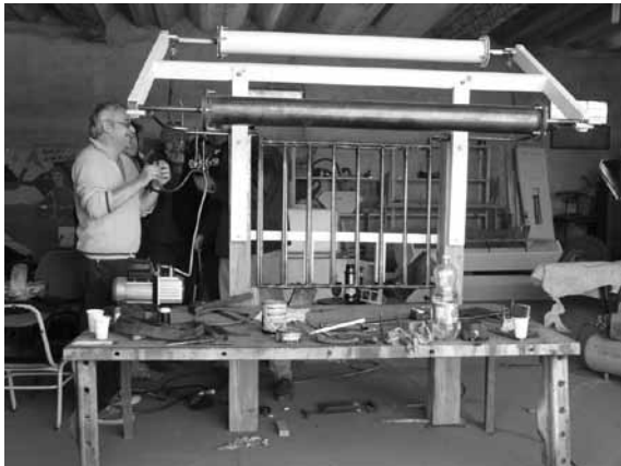
Figura 2: generación de vacío en el circuito cerrado del primer prototipo.
