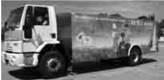
Camión cisterna con equipo de succión y lavado de tambores
