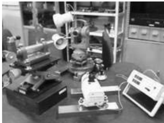
Figura 1. Calibración de teodolito en escala horizontal
