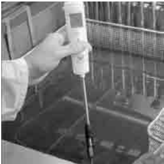
Medición de compuestos polares totales con instrumento de medición Testo 265
