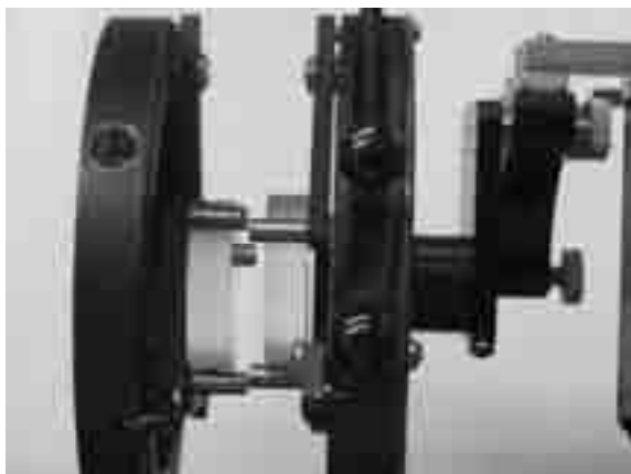
Figura 4. Detalle del sistema de sujeción de los cristales en el cual se puede apreciar la separación de las superficies
