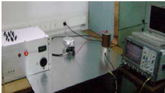
Disposición del ensayo de Impulso en un medidor de energía
