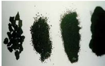
Molido de caucho de neumáticos en diferentes granulometrías
