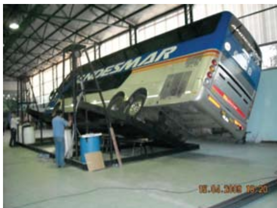
Ensayo de estabilidad en micros de doble piso
