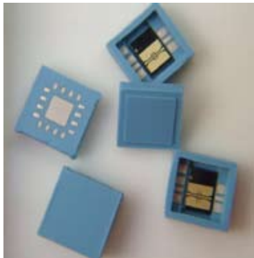
Encapsulados tipo SMD de RF-MEMS: detalle de tapa, pads (vistas superior e inferior), 5 mm lado, 1,2 mm de espesor.
