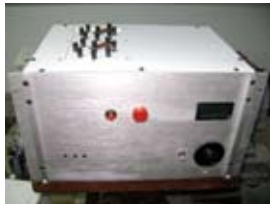
Generador Impulso Atmosférico
