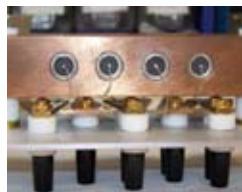
Figura 2 Imagen interior del divisor. Las resistencias están en serie por medio de las tetrabajaduras. El bloque de Cu sirve para aumentar la inercia térmica del sistema. El conexionado externo se realiza a través de los conectores binding post.
