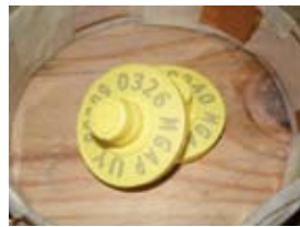
Dos transponders comerciales siendo leídos simultáneamente
