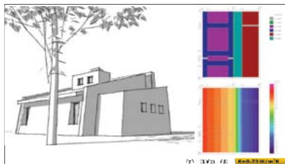
Fachada del prototipo de Zapala y estudio higratérmico de sistemas constructivos. Software utilizado: KOBRO
