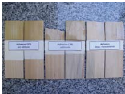
Probetas traccionadas de cada adhesivo
