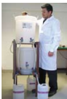
Fig. 3. Dispositivo rural para la remoción de Arsénico
