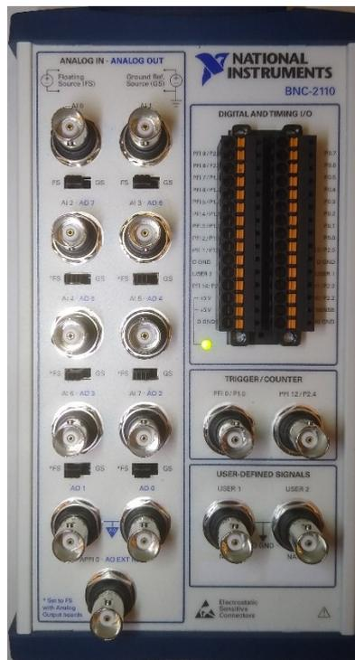
Figura 12. Imagen del accesorio BNC-2110 fabricado por National Instruments.
