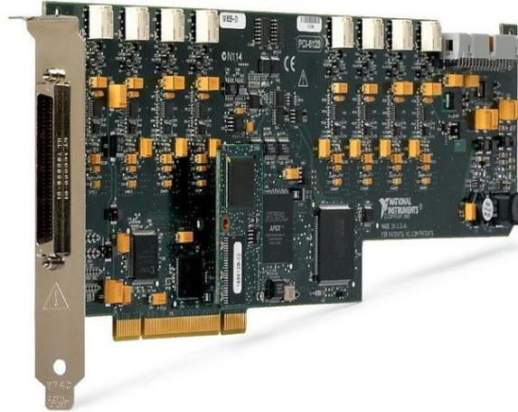
Figura 11. Imagen de la placa de adquisición NI-6133. Imagen extraída de internet ver [15].
