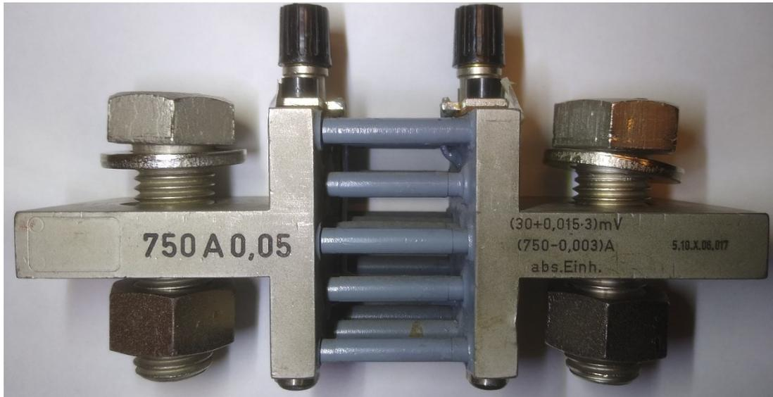
Figura 14. Imagen del resistor shunt H&B 750 A.
