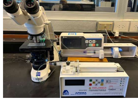
Fig. 3. Banco de caracterización para la aplicación de microflujos.
