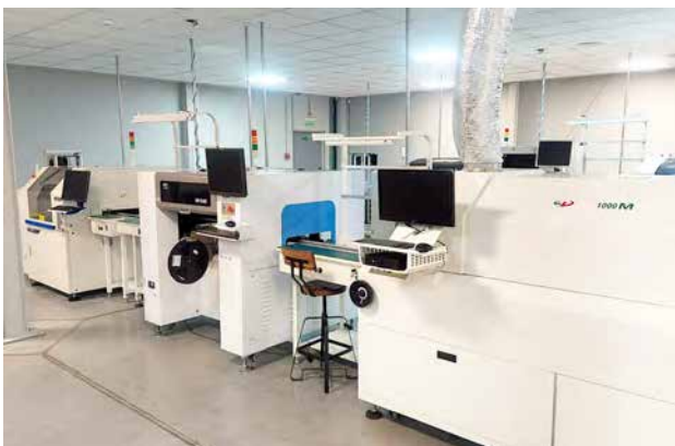
Figura 5. Línea SMT en Pixart S.R.L. De izquierda a derecha: Impresora de estencil, pick-and-place y horno de refusión.
