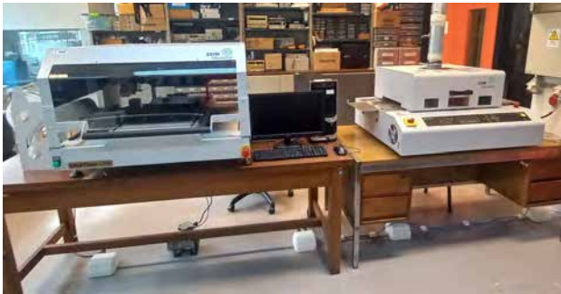
Figura 4. Línea SMT de prototipado en INTI. De izquierda a derecha: pick-and-place y horno de refusión.
