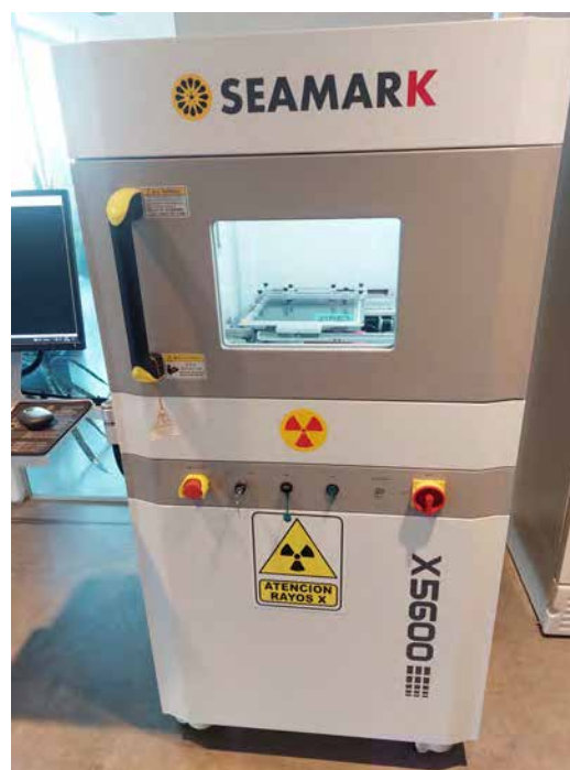
Figura 10. Equipo de rayos X con el que se obtuvieron las imágenes radiográficas.
