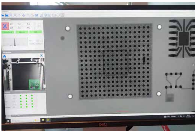
Figura 12. Pantalla del equipo radiográfico, al inspeccionar un chip BGA-256 soldado en la placa de pruebas.
