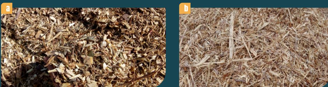
**Figura 24.** Aspecto de las astillas producidas por una cuchilla afilada (a) y una cuchilla desafilada (b).
