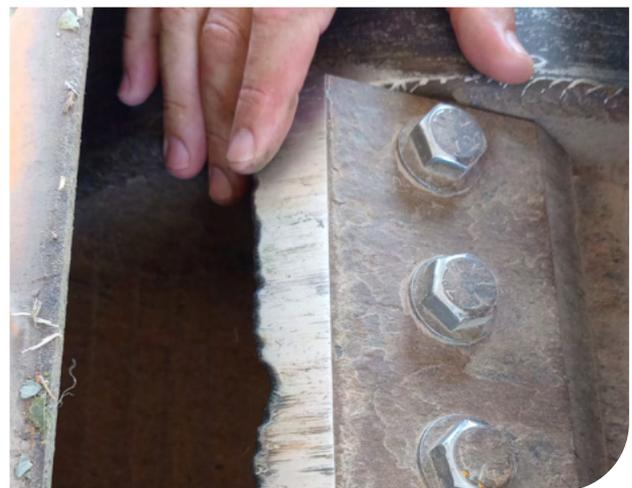
**Figura 23.** Mantenimiento de cuchillas de chipeadora de tambor.
