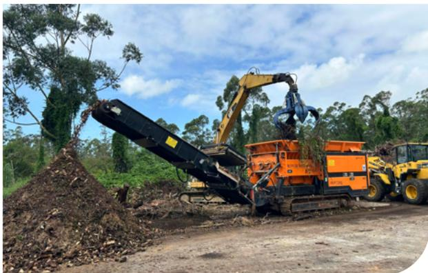
**Figura 17.** Trituradora de rodillos móvil alimentada con grúa montada sobre oruga. Composul Compostagem. Turvo, Santa Catarina, Brasil. Fuente: Marcos Aurélio Salvaro de Souza.
