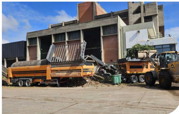
**Figura 18.** Trituradora de rodillos móvil montada sobre ruedas en línea con tamizadora para material fino (con destino a compostaje) y grueso (para energía). Planta de Tratamiento de Residuos Forestales. Gestionada por el gobierno de la CABA y operada por EVA SA.
