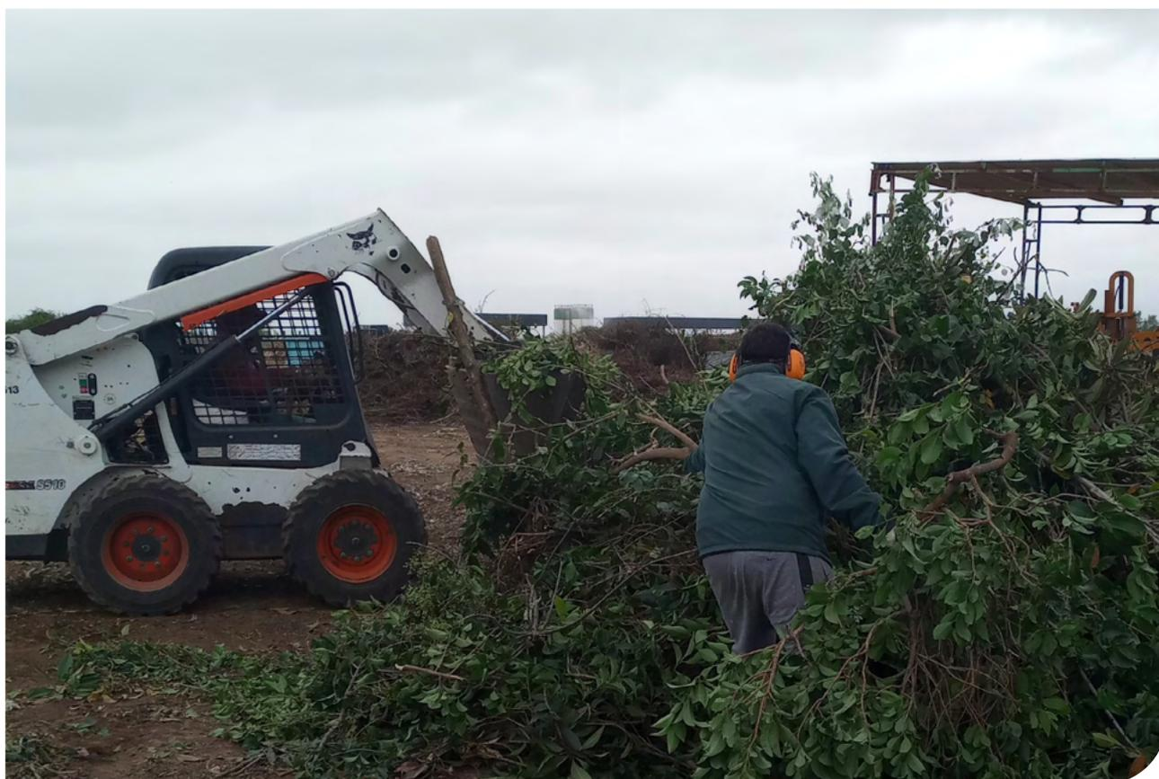
**Figura 26.** Acondicionamiento del material para alimentar la chipeadora de tambor de la planta de tratamiento de restos verdes de la ciudad de Córdoba.
