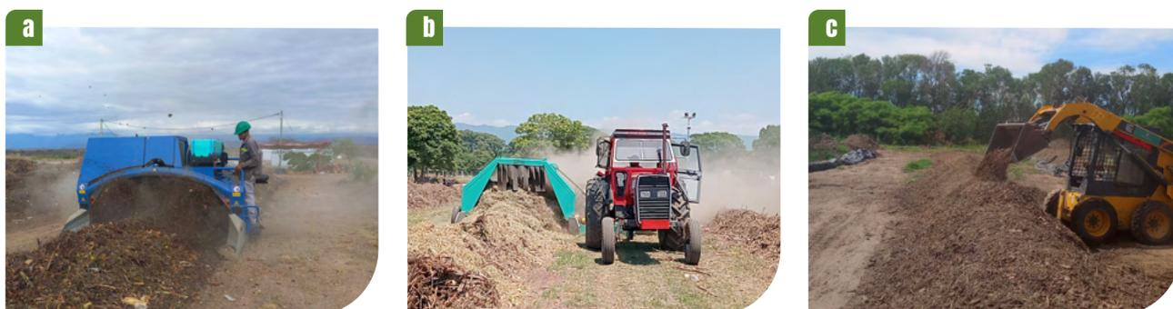
**Figura 3.** Equipamiento para volteo. a. Volteadora autopropulsada del Centro Ambiental GIRSU Jujuy S.E; b. Volteadora de arrastre de tiro lateral al tractor de la planta de compostaje de la Municipalidad de San Miguel de Tucuman; c. Minicargadora de la planta de tratamiento de residuos verdes de la municipalidad de Córdoba.
