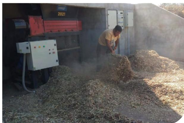
**Figura 10.** Trituradora fija de rodillos de doble eje de la municipalidad de Unquillo, Córdoba.
