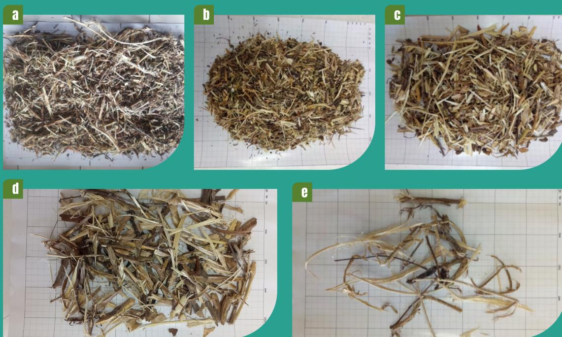
**Figura 6.** Granulometría de la fracción media de la poda triturada y tamizada: a. Sin tamizar; b. 5 mm; c. 10 mm; d. 25 mm y e. 50 mm.
