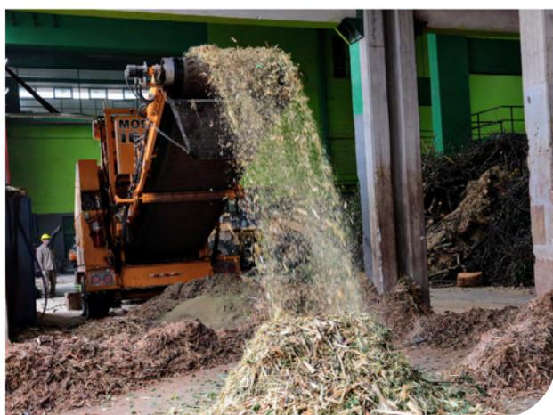
**Figura 15.** Chipeadora de tambor alimentada con pala mecánica. Planta de Tratamiento de Residuos Forestales. Gestionada por el gobierno de la Ciudad Autónoma de Buenos Aires y operada por EVA SA.
