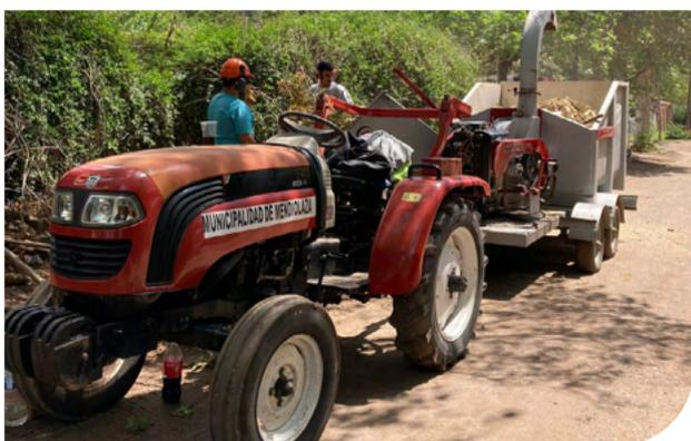
**Figura 19.** Chipeadora de discos móvil de la municipalidad de Mendiolaza, Córdoba, realizando chipeo de los RP "puerta a puerta", en los hogares de la localidad.
