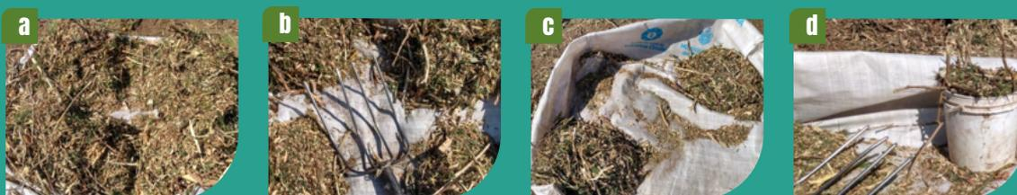
**Figura 5.** Método de cuarteo: a. El material se separa en cuatro cuartos iguales y descartan dos opuestos; b. El material se vuelve a mezclar y se repite el paso de la figura; c. el material que va quedando se vuelve a mezclar hasta lograr la muestra buscada; d. muestra compuesta de 5 litros.
