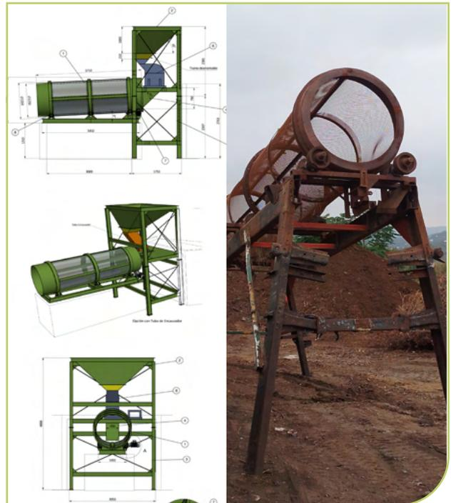
Figura 7. Diseño y construcción de tambor giratorio.
