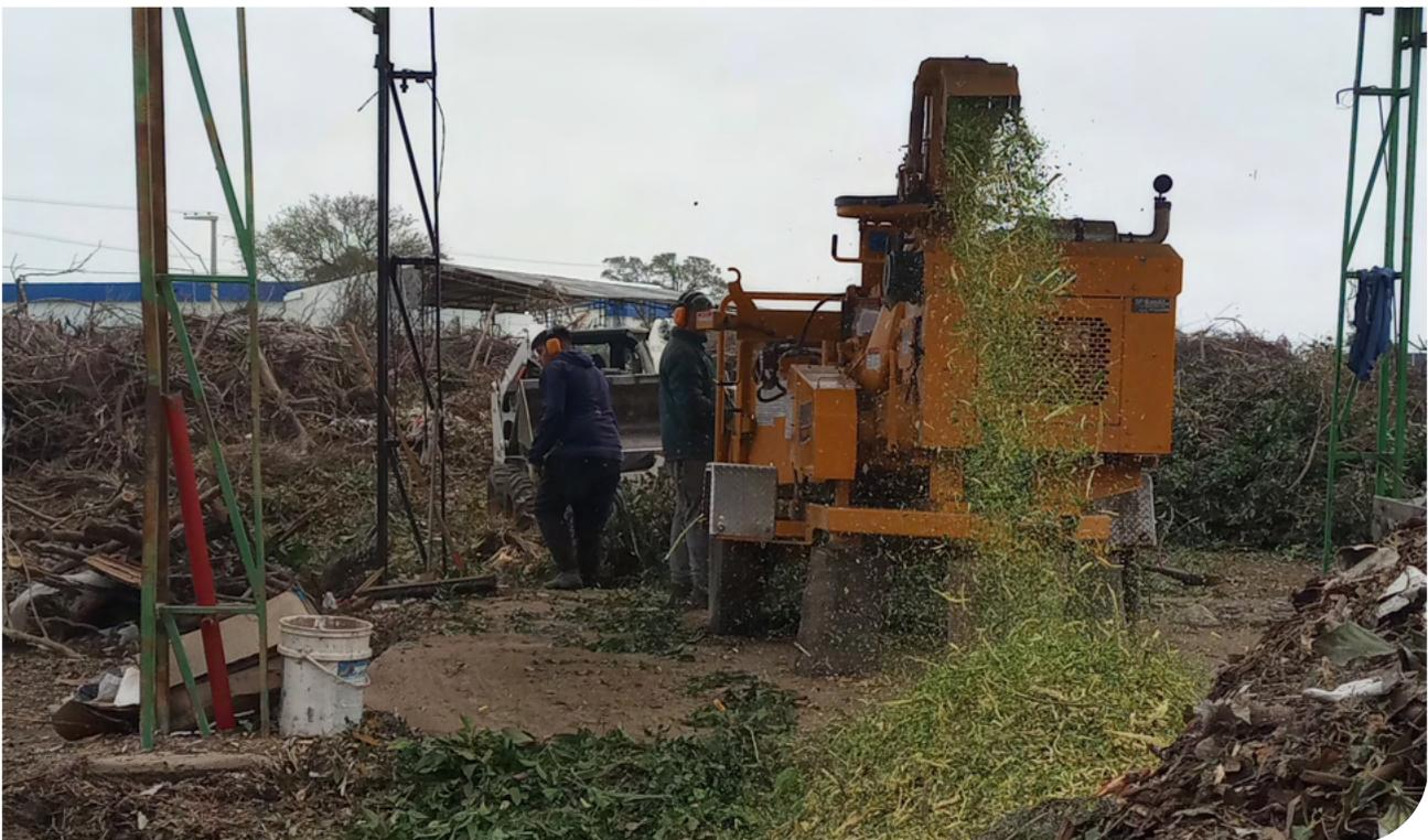
**Figura 25.** Voladura de material durante el chipeado en la planta de tratamiento de residuos verdes de la ciudad de Córdoba.
