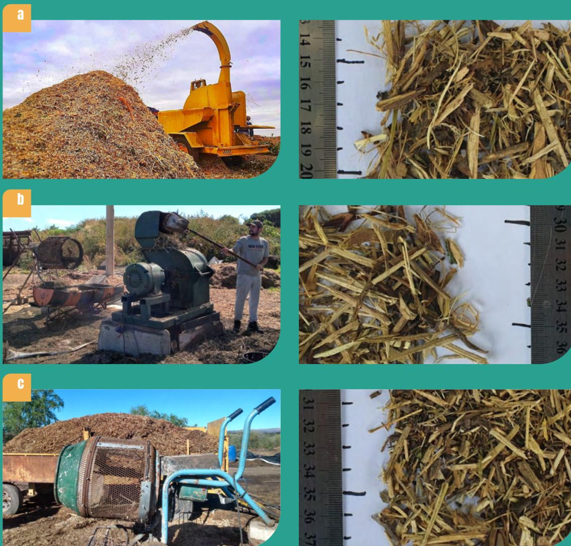
**Figura 21.** Aspecto y tamaño del material triturado según la tecnología utilizada: a. 10 g de poda triturada en chipeadora de discos, b. 10 gramos de poda triturada chipeadora de discos y luego en molino de martillo, c. 10 g de poda triturada en molino de martillo y pasada por una hormizaranda de 10 mm.
