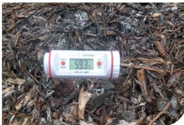
**Figura 8.** Puntos de inserción del termómetro de varilla para monitoreo de temperatura.
