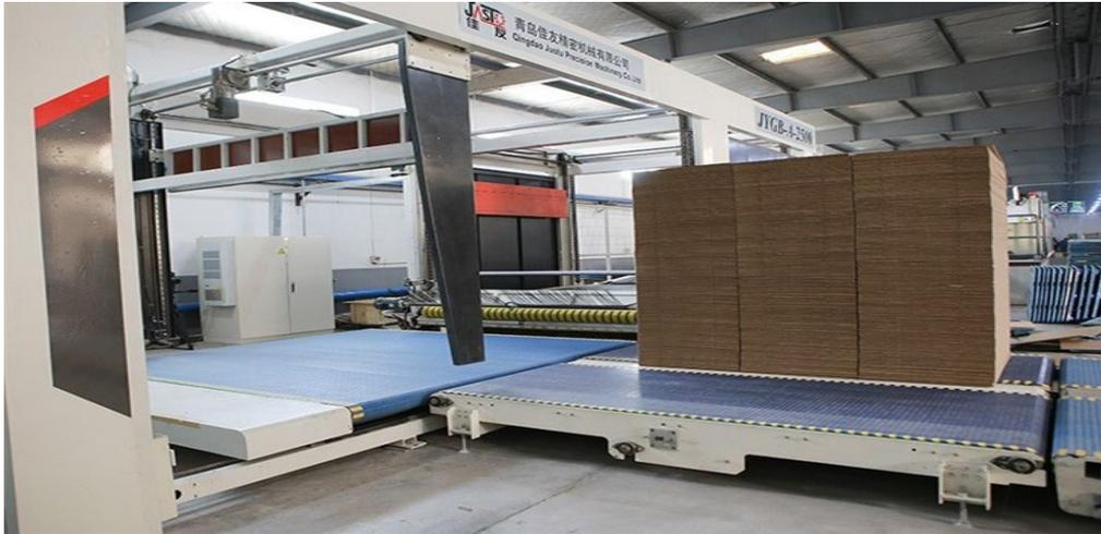
Figura 10. Apilamiento de láminas de cartón corrugado a la salida del stacker.
