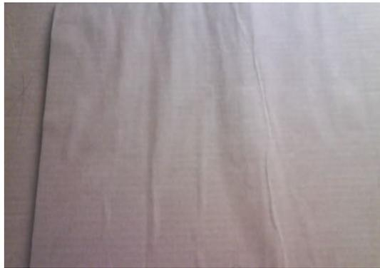
Figura 30. Liner arrugado en lámina de cartón.
