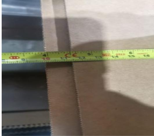
Figura 28. Diferencia de medidas entre láminas de cartón.
