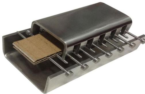
Figura 20. Pines utilizados en la medición del PAT del cartón corrugado.
