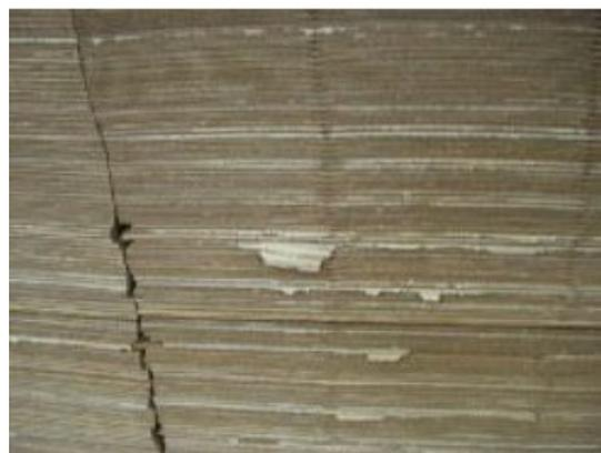
Figura 27. Corte defectuoso en lámina de cartón.
