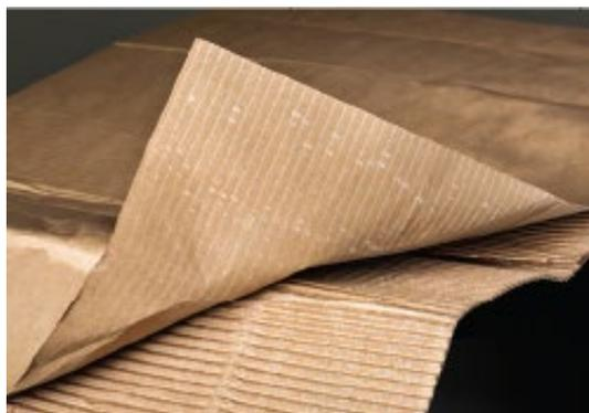
Figura 29. Presencia de grumos en lámina de cartón.
