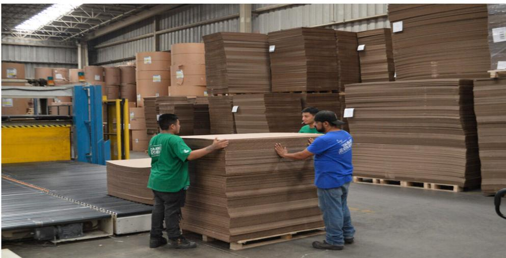
Figura 11. Paletizado de láminas de cartón corrugado.
