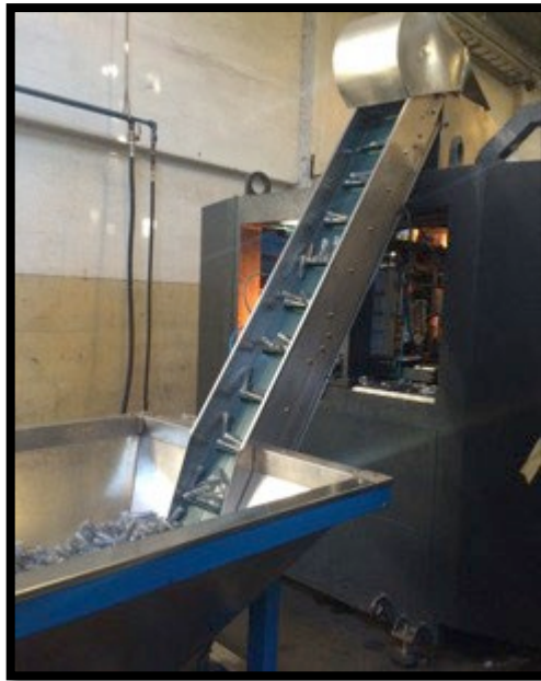
Imagen 10: inyección de preformas en la maquina sopladora
