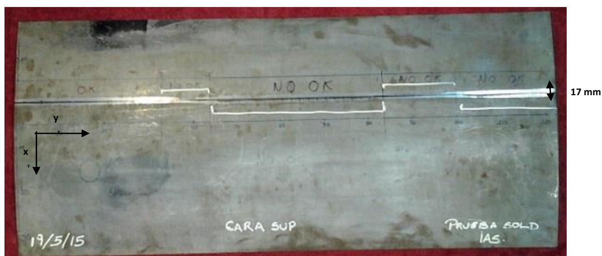
Figura 2.3. Chapa 2 con las diferentes zonas “bien” soldada (OK) en el lado izquierdo y “mal” soldada (NO OK) en el resto.
