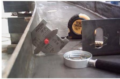
Figura 1.15. Inspección visual en la soldadura.
