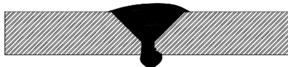
Figura 1.6. Exceso de penetración en la soldadura
