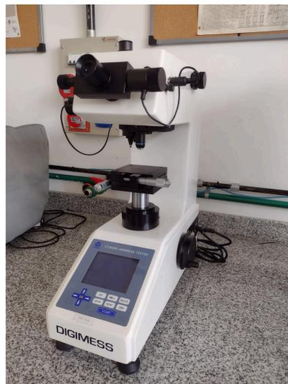
*Figura 10 - Microdurómetro Vickers MHVD-1000AP*
