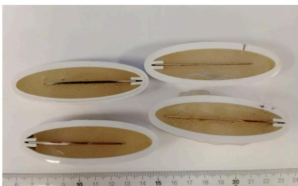
Figura 7 - Probetas incluidas en Frío con Resina
