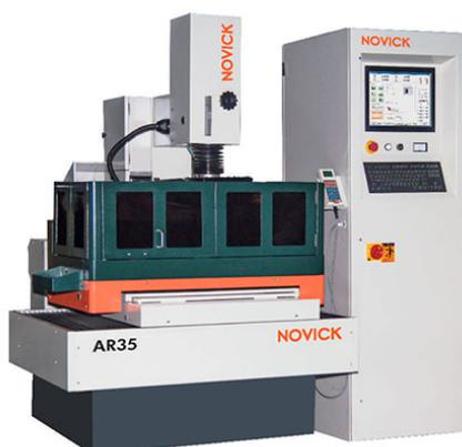
Figura 3 - Máquina de Electroerosión
