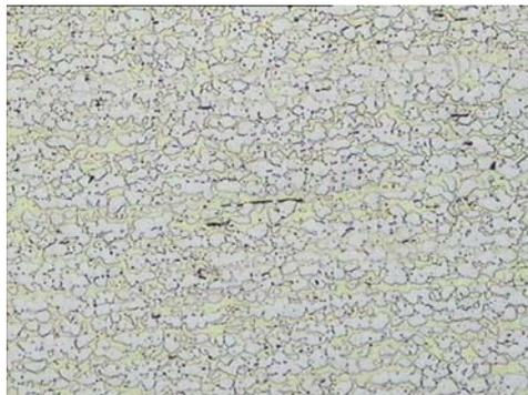
Figura 6: Microestructura del latón amarillo a agujerear (100X).
