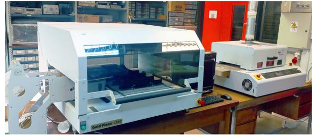
Figura 3. Línea SMT de prototipado en INTI. De izquierda a derecha: Pick and Place y horno de refusión.
