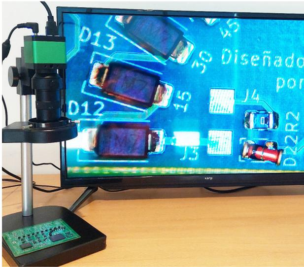
Figura 10. Configuración errónea del componente D22 en la Pick and Place.
