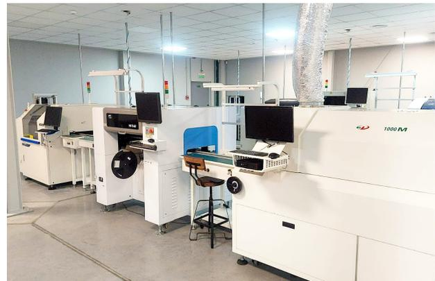
Figura 4. Línea SMT en Pixart S.R.L. De izquierda a derecha: Impresora de stencil, Pick and Place y horno de refusión.
